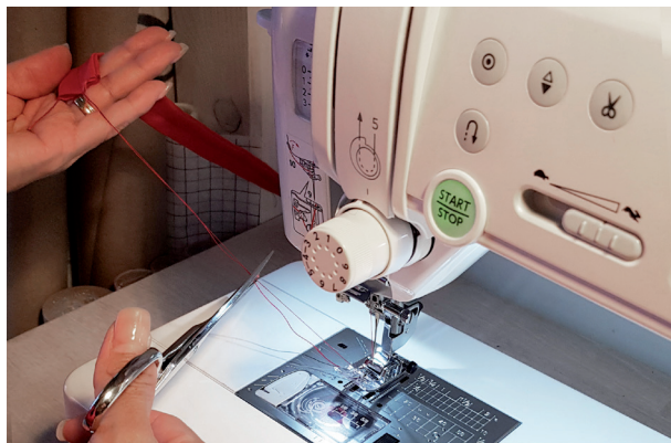
19. Beim Herausnehmen der Arbeit aus der Maschine bei ganz angehobener Nadel den Faden weit herausziehen und gut zehn Zentimeter Faden am Ende der Naht stehen lassen.
