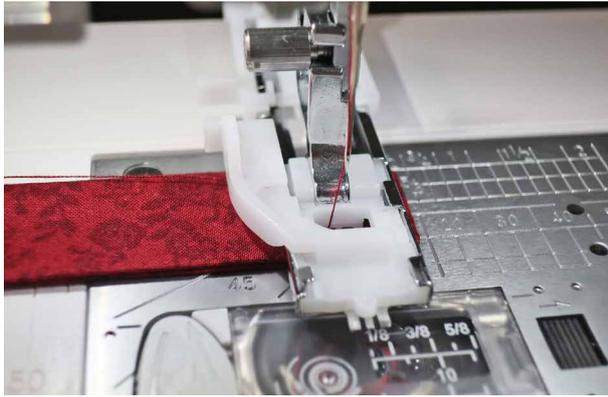
9. Den automatischen Knopflochfuß (R) einsetzen und den Knopf in den Knopflochfuß einlegen, um die Knopflochgröße festzustellen. Auf Ihrem Stoff die Knopflöcher markieren, die im Schnittmuster angegeben sind. Anschließend den Stoff für jedes Knopfloch unter den Nähfuß legen und an der Startmarkierung ausrichten. Einen Knopflochtyp auswählen und nähen, dabei den Stoff führen.
