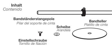
\* Die Einstellschraube und die Scheibe sind mit der Bandständer-Stange verbunden.
